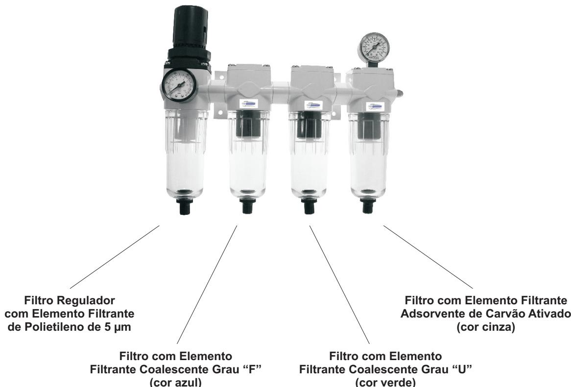
**Filtro Regulador:** mantém a pressão de operação constante, independente das flutuações da pressão primária e do consumo de ar; pré-filtragem dos filtros coalescentes, retendo as partículas sólidas e gotas de umidade com valor absoluto de 0,3 a 0,6 µm.
